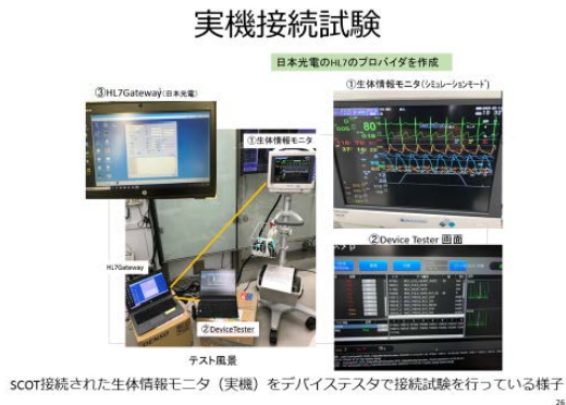
図8 実機接続試験
