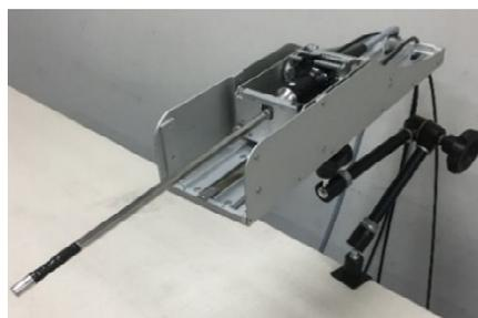
図 1 内視鏡操作ロボット
