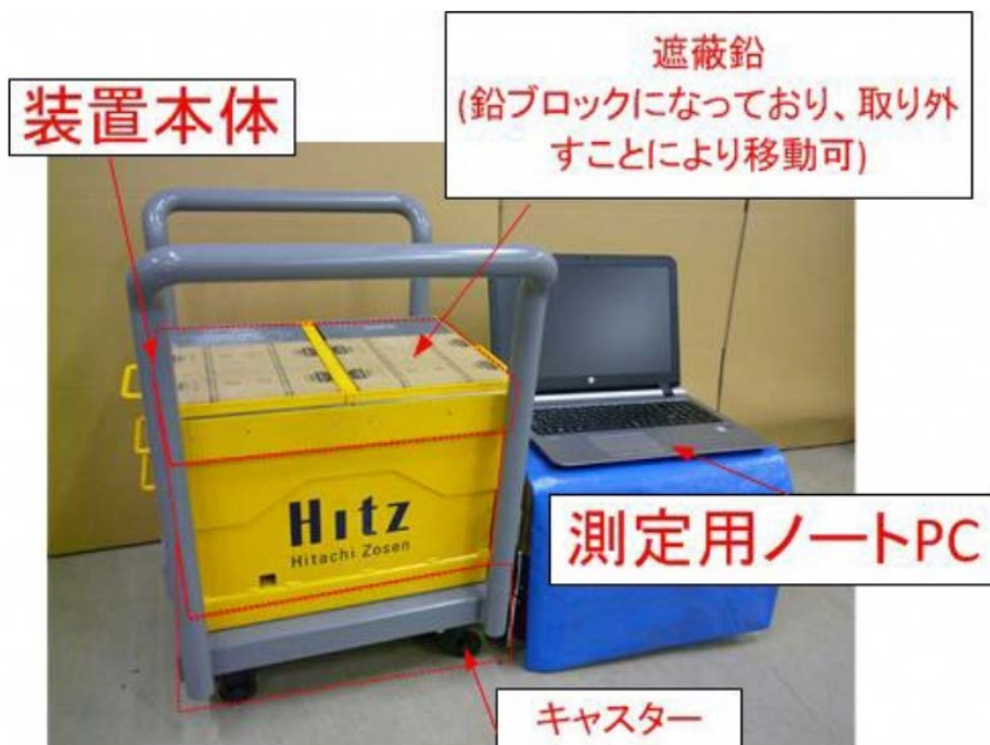
図1 日立造船（株）製 簡易検査装置の外観
