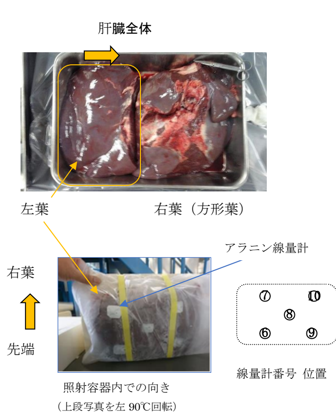
図 1 0. 凍結肝臓試料の線量分布測定結果：肝臓左葉試料の様子（左）、試料内の線量分布（右）
