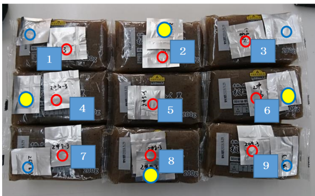
図 5. 模擬試料(こんにゃく)への線量計取り付け手順(上)、と 1 面 9 枚のこんにゃくを組み合わせた際のこんにゃく位置の番号と線量計位置
