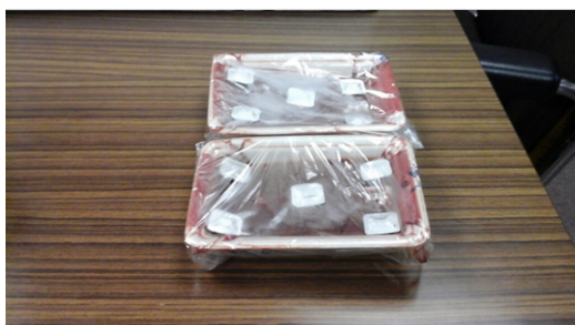
図3. 肝臓切り身試料の包装とアラニン線量計の取り付け
