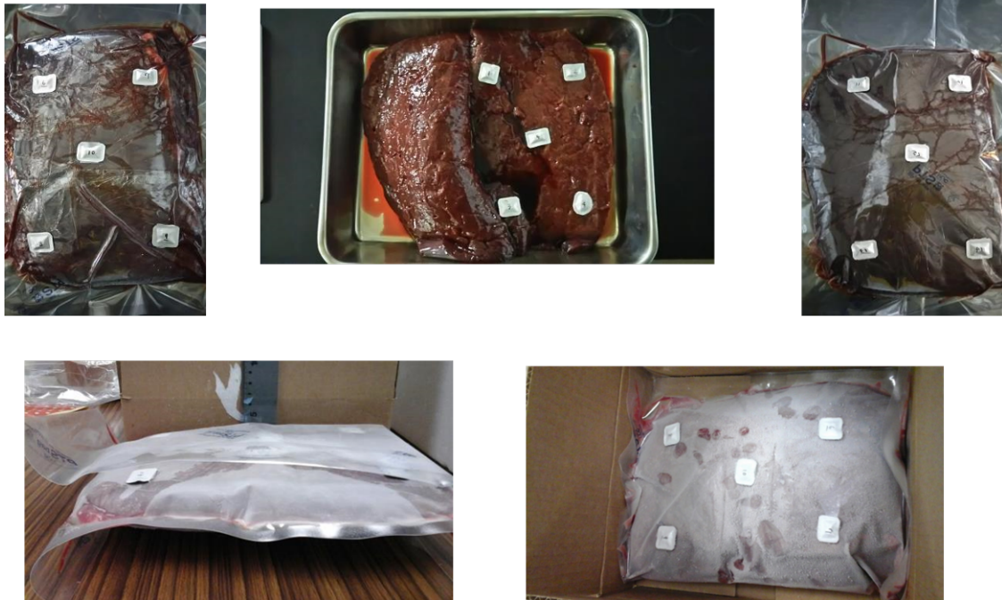
図2. 肝臓左葉へのアラニン線量計の取り付け
