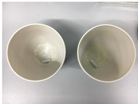
Fig. 6-15 食用赤色3号の灰化後の様子（タール色素試験法と素試験法）
