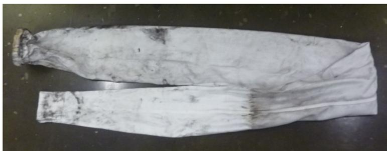
ろ布を逆さ吊りで、気流は袋状のろ布内部から外へ流れる。捕集された粉じんはろ布内部に溜まっており、取り出し直後は、ろ布外面は真っ白な状態であった。写真の表面の汚れは取り外し後に粉じんがこぼれた結果。
