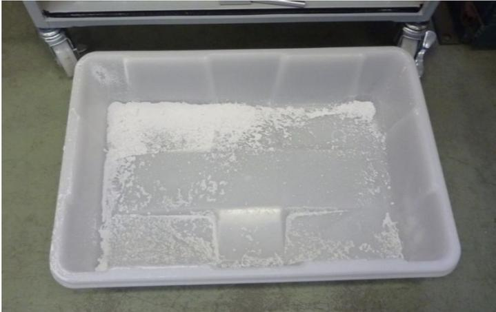
図4 - 2 3 払落し直後のダストバケットの石灰粉
