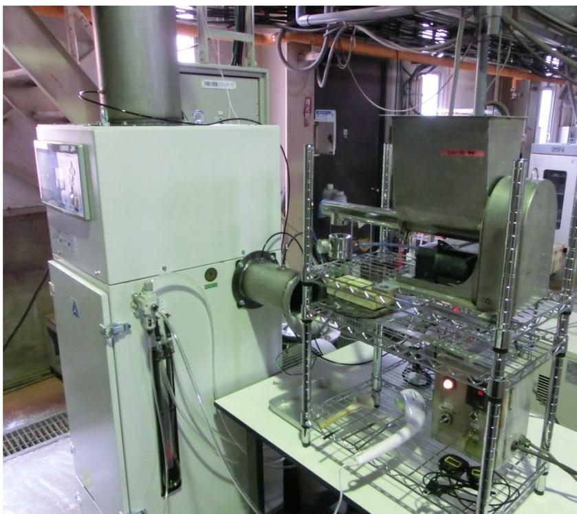
図2-6 パルスジェット式除じん装置の装置構成（広島大学）
