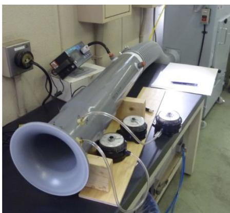
図 4 - 1 3 入口のベルマウスと圧力タップ
