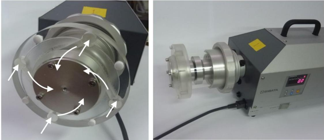
図3 - 7 ハイボリウムエアサンプラ用のサイクロン
