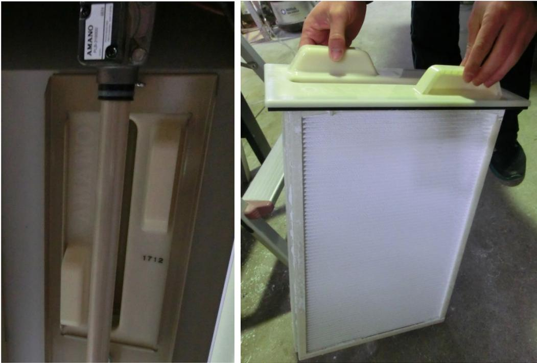
図2 - 7 フィルタの状態 左 装てん状態、 右 取り外した状態
