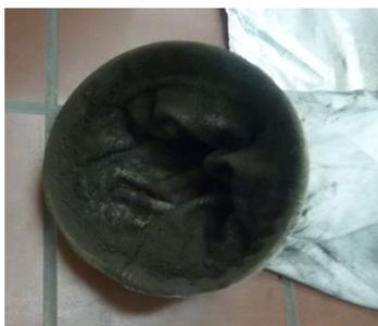
ろ布内の粉じんを回収し、これを走査型電子顕微鏡で写真撮影した。また付属するエネルギー分散型X線分析 (Energy dispersive X-ray spectrometry、EDX、EDS)で溶接に由来すると思われる表示のような種類の元素が認められた。
