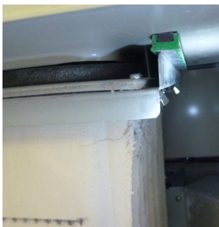
図3 - 16 ろ布の取り付け状態の検討
