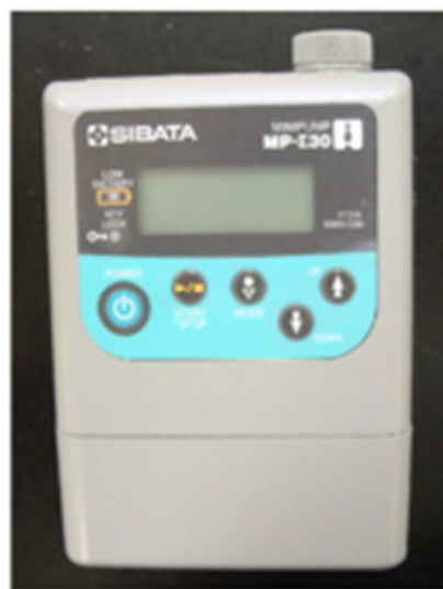
Photo 4 捕集管採気用ポンプ MP -30、(柴田科学)
