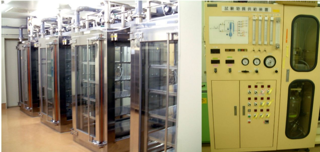
Photo 1 3m 3 横層流大型チャンバー及びその発生装置(柴田科学)
