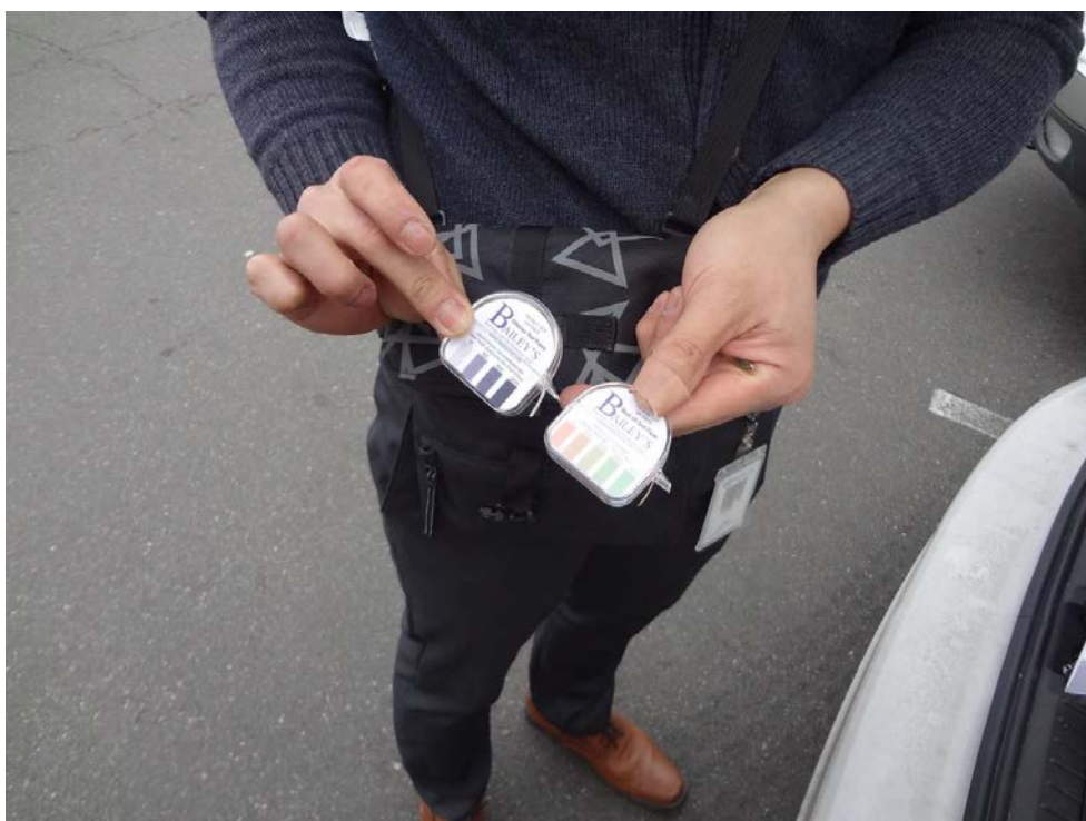
写真4：洗剤濃度測定キットおよび残留塩素測定キット
