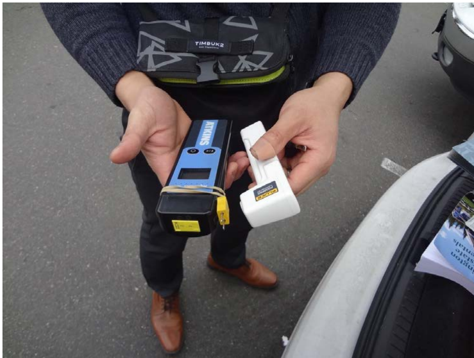
写真1：温度計（中心温度計および放射温度計）
