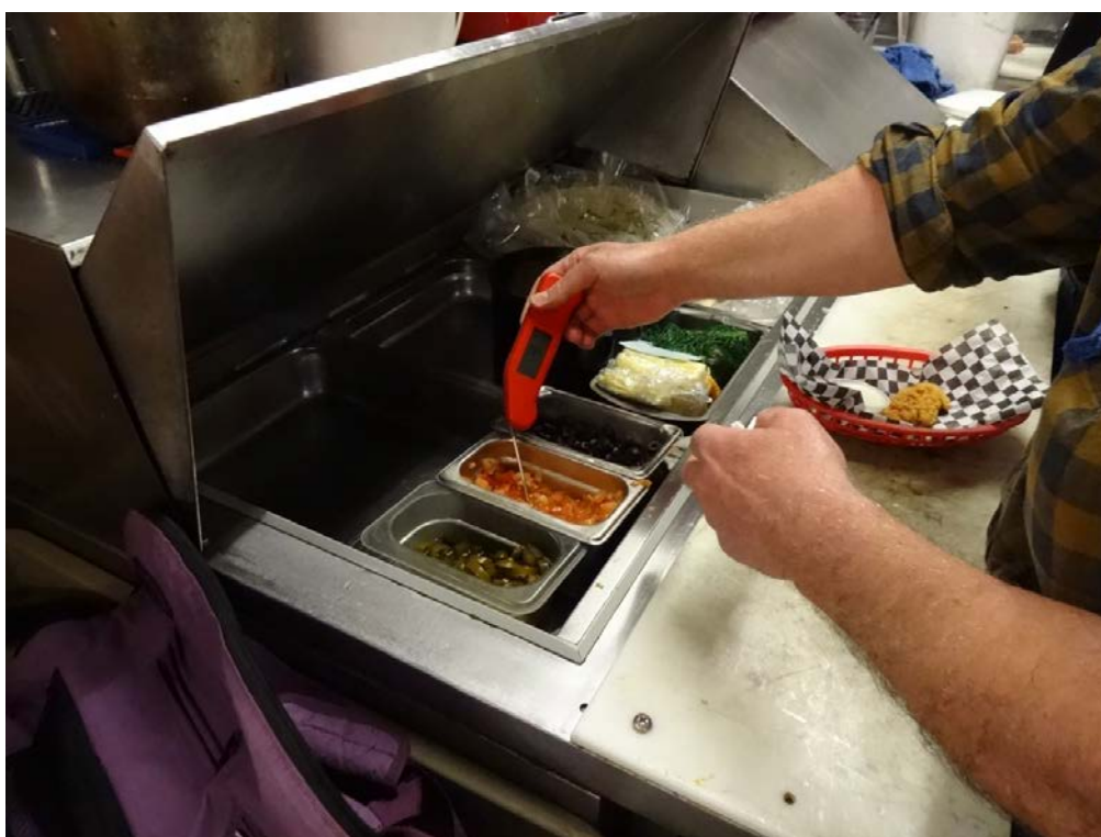
写真1 2：サルサソース等の冷蔵温度測定
