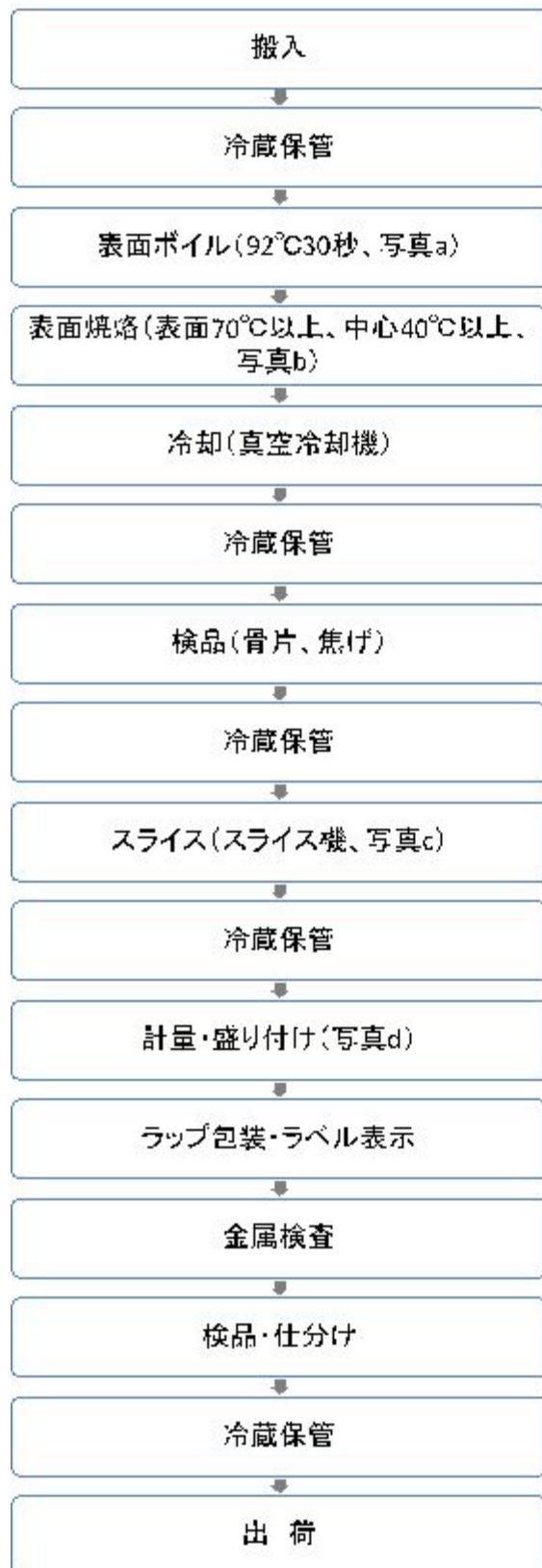
図3 もも肉加工工程（写真a：ポイル槽、b：焼烙機、c：スライス後、d：盛り付け後）
