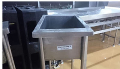
写真2-6 と鳥の汚れが目視された時に、と鳥を浸す消毒槽(塩素濃度50-100ppm)
