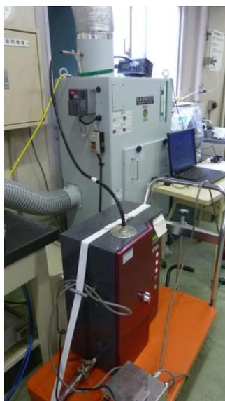
図 3 - 8 電氣的低圧インパクト（ELPI）の分離粒径と外観（手前の台車上）
