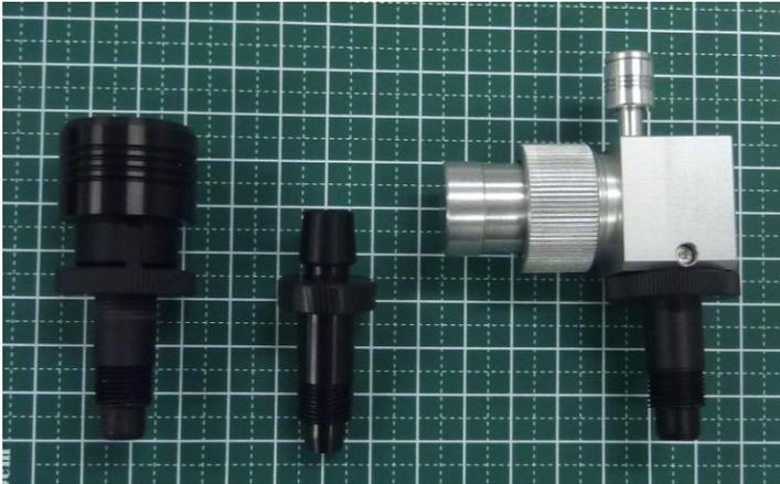
図3 - 2 本体から外したLD - 5入口（左）とPM2.5サイクロン（右）、中央はインライン吸入口
