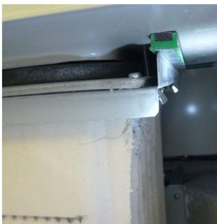
図3 - 15 ろ布の取り付け状態の検討
