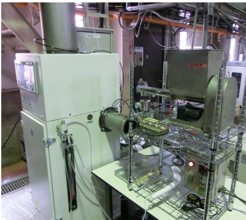
図2-3 パルスジェット式除じん装置の装置構成（広島大学）
