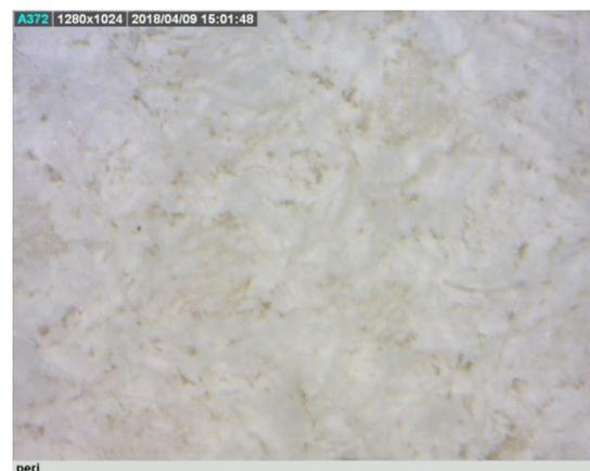
最終の石灰粉堆積状態、(左)吸引口と反対側のろ布表面 (右)吸引口側のろ布表面
