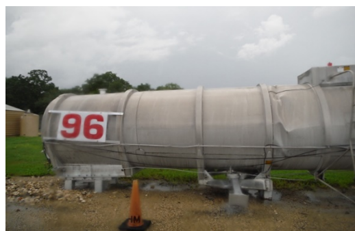
図 4 危険物が充てんされている貯槽が破損したことを想定した訓練施設
