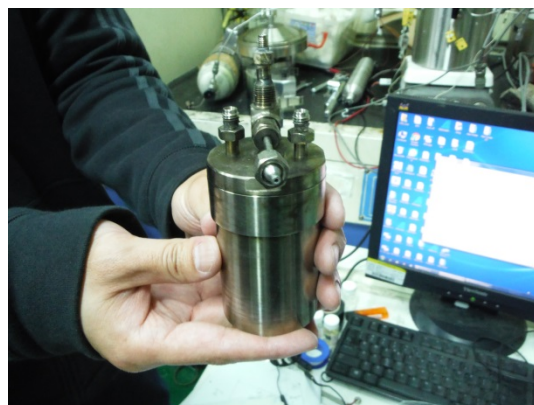
図15 電池分析用に改良された VSP 用試料容器
