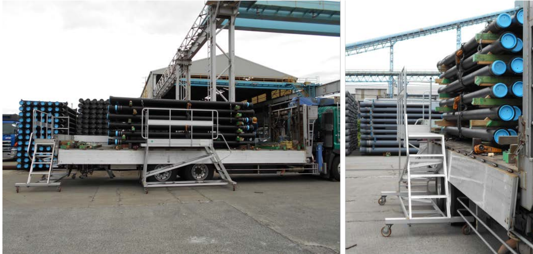
図 1 3. 現場で使用されていた荷台から墜落防止対策
