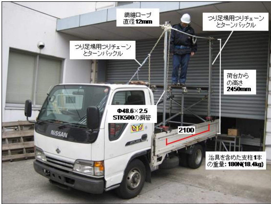
トラック積載型の安全带取付設備に安全带をかけた状態
