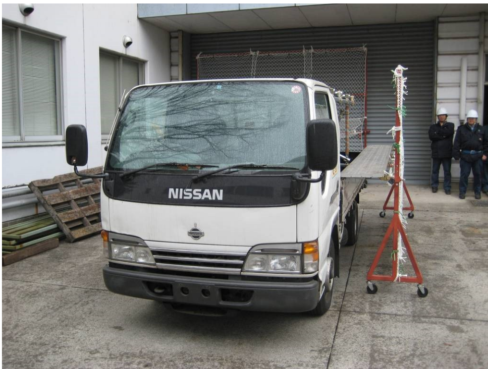
荷主庭先据置型の作業床をあおりに取り付けた状態
