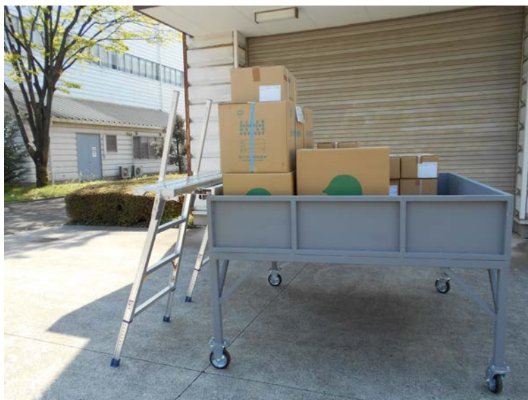
土台となるステップ2台を設置し足場板を設置した状態
