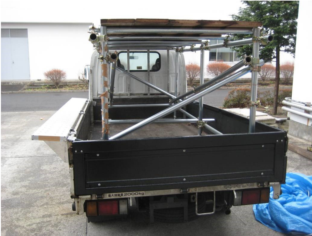
トラック積載型の作業床をあおりに取り付けた状態
