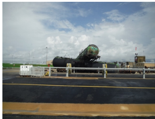
図 3 貨物車両が脱線したことを想定した訓練設備
