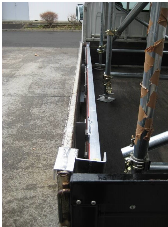
トラック積載型の作業床を収納した状態
