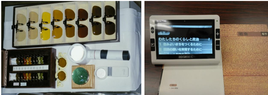
(図：小児に対する光学的補助具：眩しさに対する遮光レンズ、拡大鏡、単眼鏡、拡大読書器)
