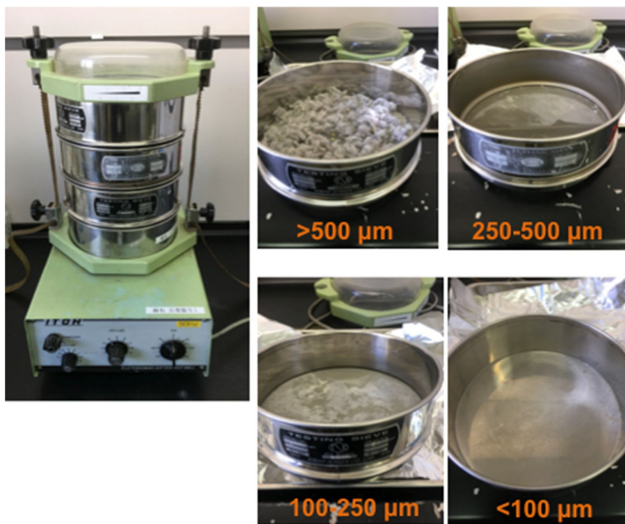
Fig. 2 ダストの自動ふるい装置と粒径別のダスト
