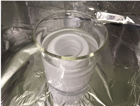
図1 使用器具のアセトン洗浄
