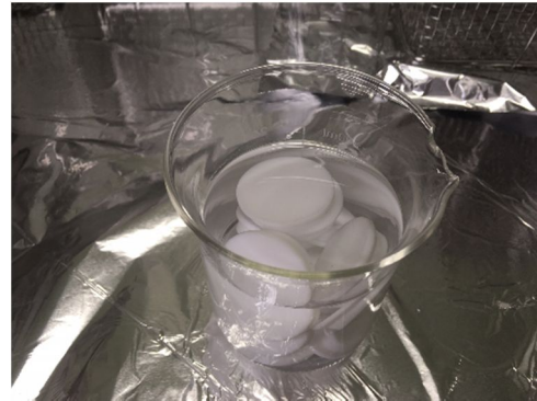
図1 使用器具のアセトン洗浄
