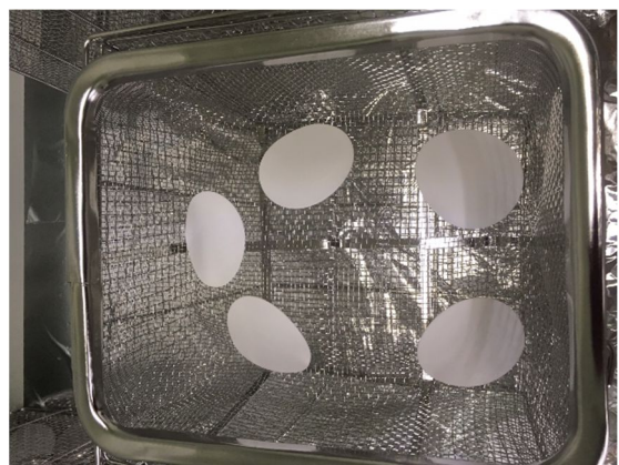
図2 空気捕集剤 (Empore Disk C18 Fast flow) のアセトン洗浄・風乾
