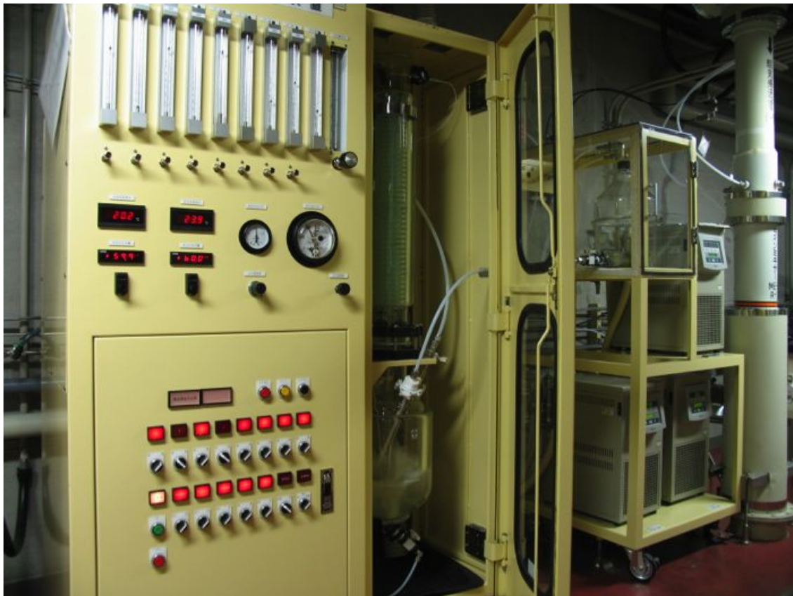
図5. ホルムアルデヒドの発生装置
