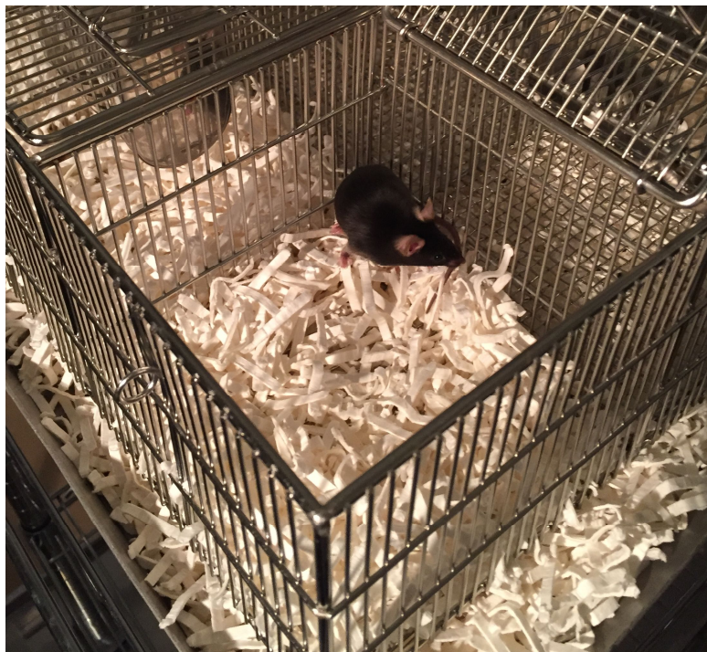
Photo 4 トレイ上にパルプ製床敷(パルマス \mu )を敷き、暴露ケージに密着させ、金網ケージ内にも床敷を敷いた状態。
