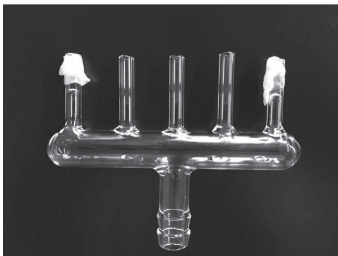
図1 分岐管 5本の出口のうち3本を使用。 出口の口径は3mm
