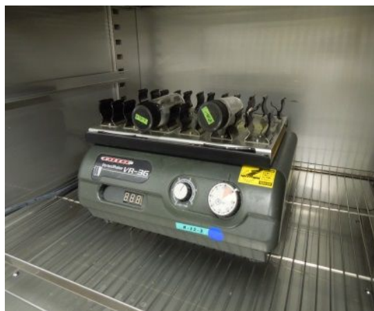
図 1 回転式振とう機を用いた溶出試験の様子
