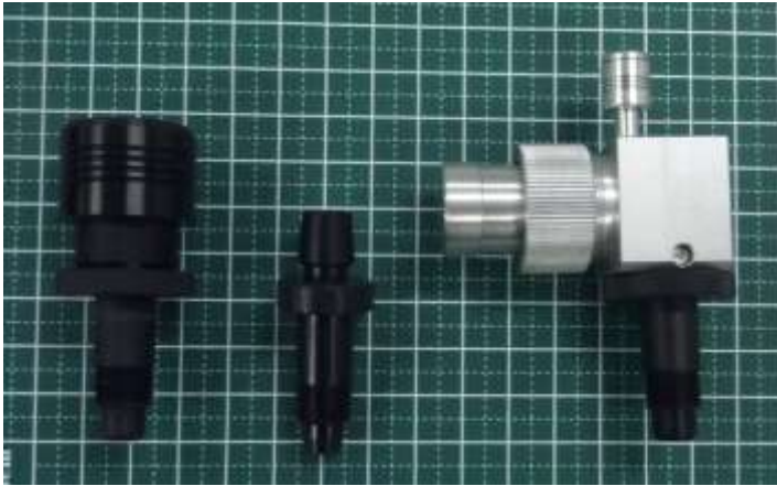
図2-4 本体から外したLD-5入口（左）とPM2.5サイクロン（右）、中央は通常のインライン吸入口
