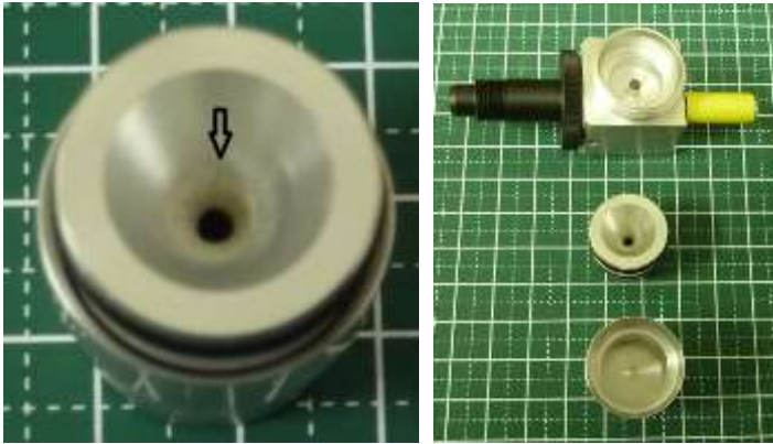
図3-24 除じん装置入口のLD-5①に取り付けたPM2.5サイクロン内部に捕集された粉じん（測定3、実質15分間のサンプリング）
