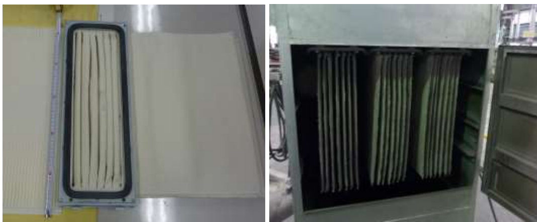
図3-18 ろ布と取り付け金具からなるろ布ユニットと除じん装置に取り付けた状態 （左は新品で右側がろ布の袋、巻尺より左側が挿入するプラスチックスペーサー、右は装着して2ヶ月ほど使用後）
