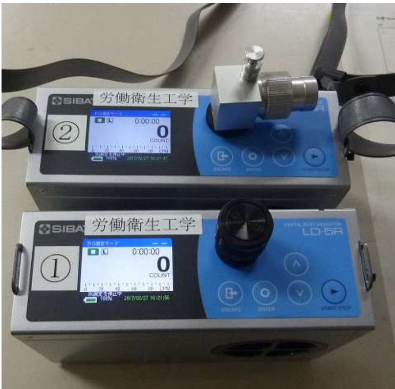
図 2-3 PM2.5 サイクロンを取り付けた LD-5 R (上) 元々の柴田科学 LD-5 R (下)
