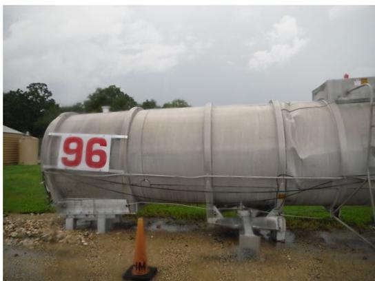
図 4 危険物が充てんされている貯槽が破損したことを想定した訓練施設
