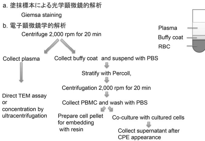
図 1. 血液中のウイルス粒子の迅速検出法の標準手順。不活化は 2%-4% グルタルアルデヒドもしくは 2% パラフォルムアルデヒド液で 30 分～2 時間室温固定 (200  $\mu$ l で十分) し、紫外線照射との組み合わせで行う。
