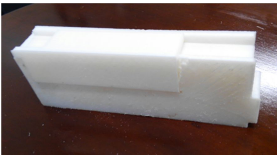
図 5 点字ディスプレイとノートパソコンを重ねて使用するためのアダプタ収納時分解した状態
