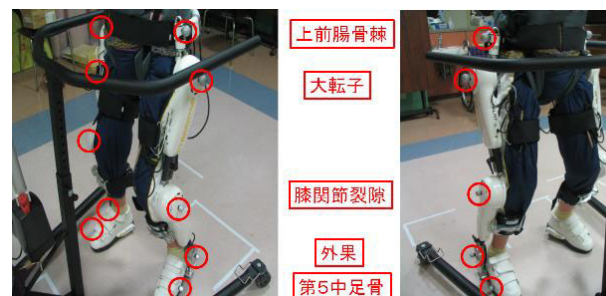
図4 HAL 歩行のマーカー位置 HAL なし歩行と同様の位置にマーカーを貼付した。
