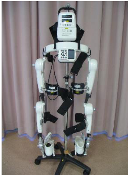
図1 ロボットスーツ HAL (Hybrid Assistive Limb®) HAL-FL05 シリーズ
