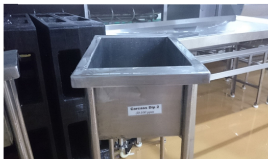
写真2-7 と鳥の汚れが目視された時 に、と鳥を浸す消毒槽 (塩素濃度100ppm)
