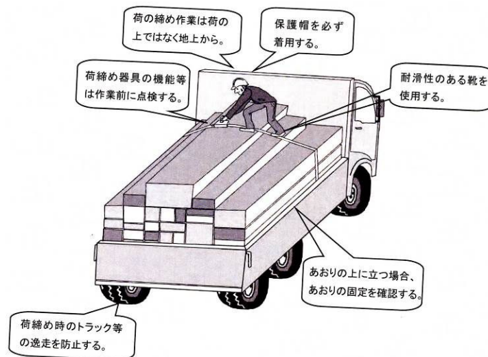
図5．荷の締め作業における基本対策
