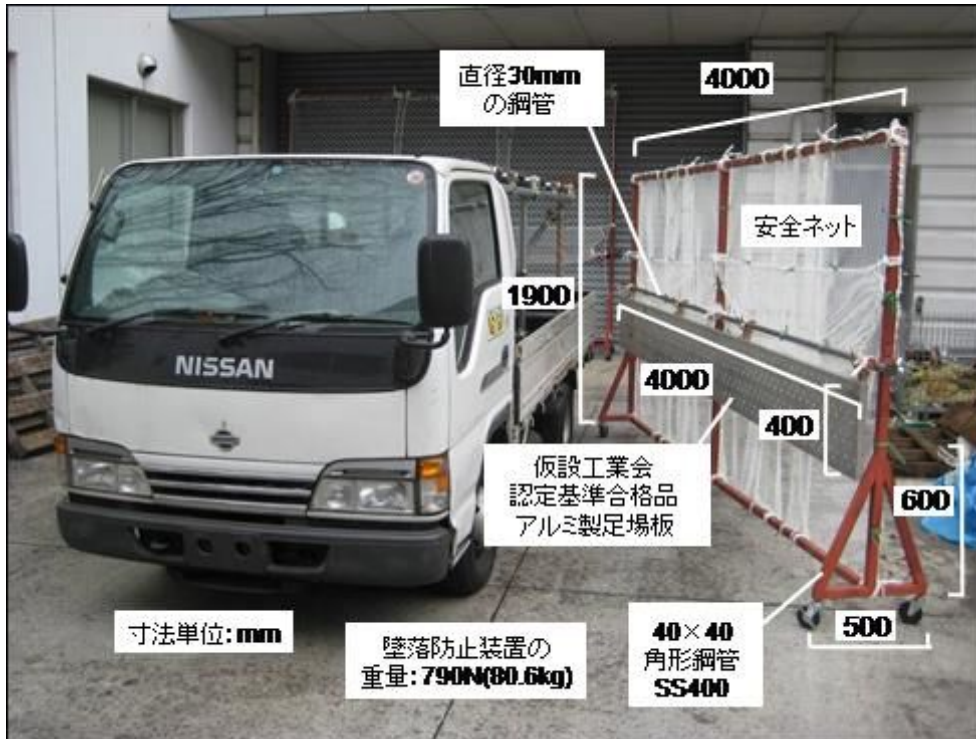
荷主庭先据置型の作業床をあおりに取り付ける前の状態
