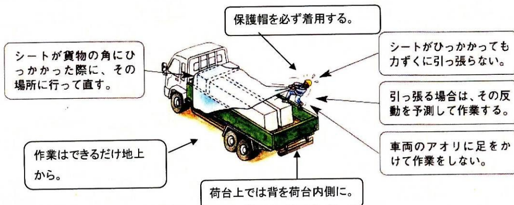
図6．荷のシート掛け作業における基本対策
