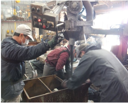
図 2.3 手込み作業風景
