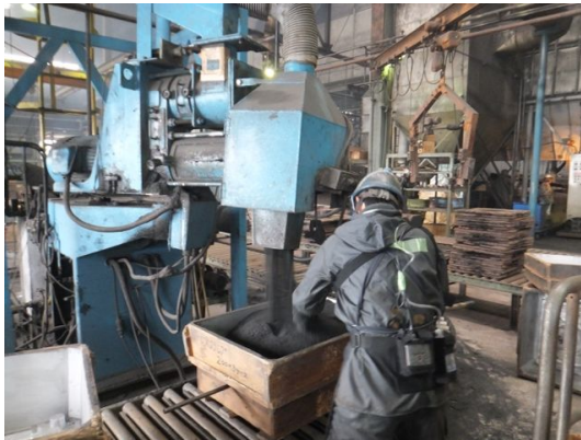
図 2.5 手込み作業風景
