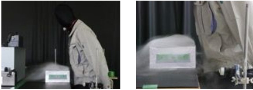
図 7.36 実験の様子（左：全体図、右：測定点 に漏洩している時の様子、フード 1、排風量 3\text{m}^3/\text{min} 、位置 450\text{mm} ）
