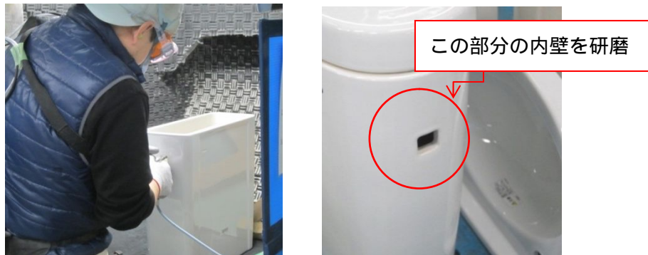
図 4.96 囲い式フードを通常時の 3 分の 1 の吸引風速にした時の作業状況
