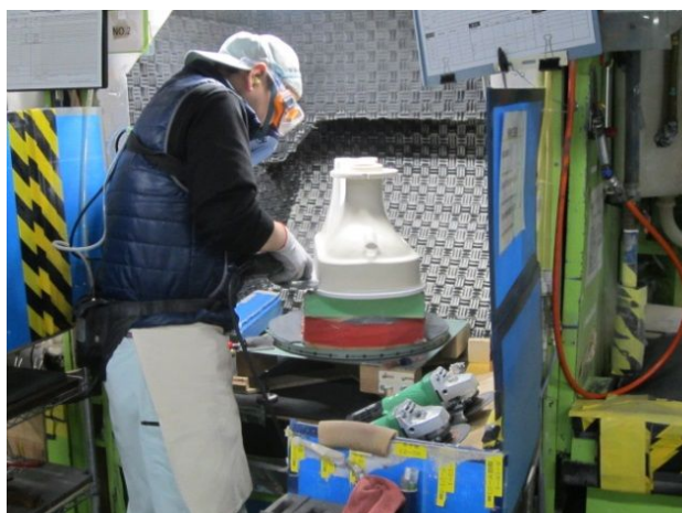
図 4.87 衛生陶器の研磨作業の作業状況
