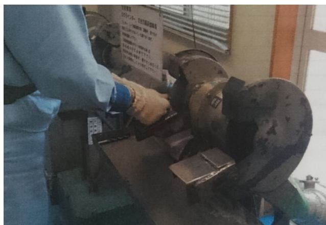
図 4.82 粉じん漏洩濃度測定時の研磨作業状況
