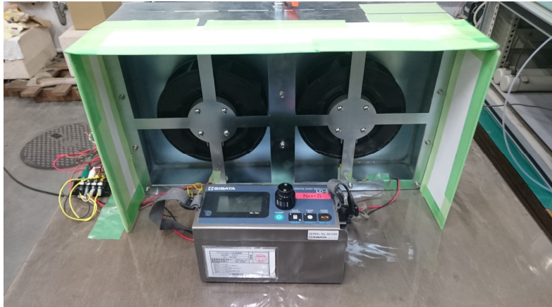
図 4.69 フィルター通過後の濃度測定状況
