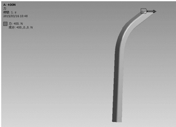
図4 作成した3Dモデルと、シミュレーションで加えた力
