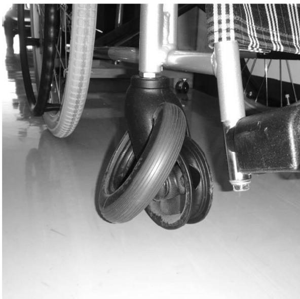
図2. キャスター破損の様子
