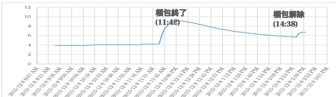
採取リンパ球ならびに作製された試験物の輸送後の細胞生存率はともに 90%以上で、細菌汚染もなかった。今回の輸送パッケージでの保冷時間 3 時間、輸送総時間 6 時間 30 分程度におけるリンパ球の品質は十分確保できたと考える。ただし、今回の輸送パッケージの庫内温度は予想より高め（10~6℃）で推移していた。これは、3 次容器の容量が大きいために、梱包後の冷却に時間がかかっていることが推察される。また、パッケージ総重量も 15 kg、容器サイズも 560x450x360mm で、運搬が容易ではなかった。本臨床研究に際しても、輸送リンパ球の容量は 500ml 前後であり、次回輸送パッケージは 520 × 320 × 375mm で 9 Kg の容器に変更した。
