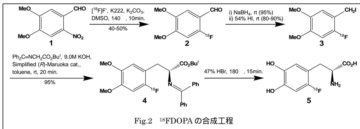
Fig.2  $^{18}\text{F}$ DOPAの合成工程
