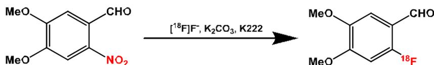
Fig.3  $^{18}\text{F}$  化反応
