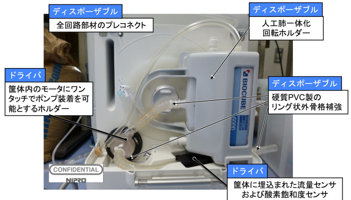
図3 駆動時は人工肺が90度回転して結露防止機構が機能する
