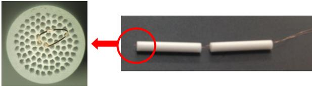
図 -8：導線を貫通させた多孔円筒
