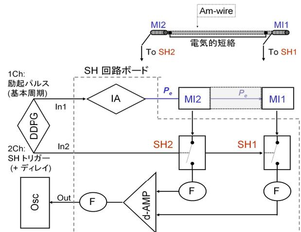
図-1：磁気直線のMI素子を駆動するシステムのブロックダイアグラム。SH回路ボードに接続された磁気直線のMI素子は、外部のデジタルディレイパルスジェネレータ(DDPG)で制御され、応答をオシロスコープ(Osc)で観察。
