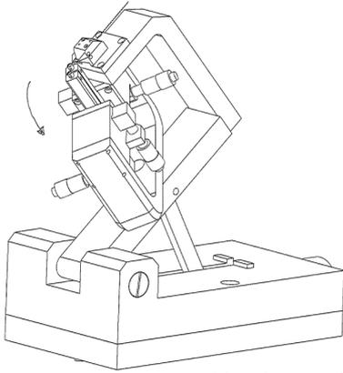
図 -7：ワーク取り付け部の回転
