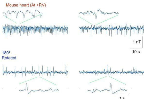
図 - 2：磁気直線的MI素子による摘出心筋標本での磁界計測。マウス右心室を（左右）心房とともに摘出しMI1状に設置した。自発性に発生する磁界は、標本を反転(180°rotation)すると反転した。
