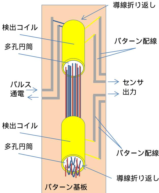
図 -2：IPA センサヘッドの構成
