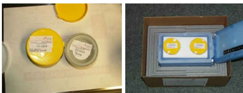
図 1 輸送用容器（外側容器と内側容器）の外観(左)、輸送用断熱箱にセットした写真(右)
