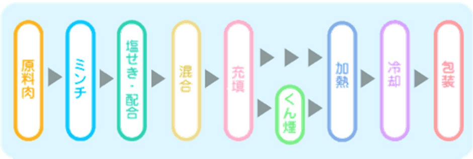
図表 3-5 ソーセージの製造工程
