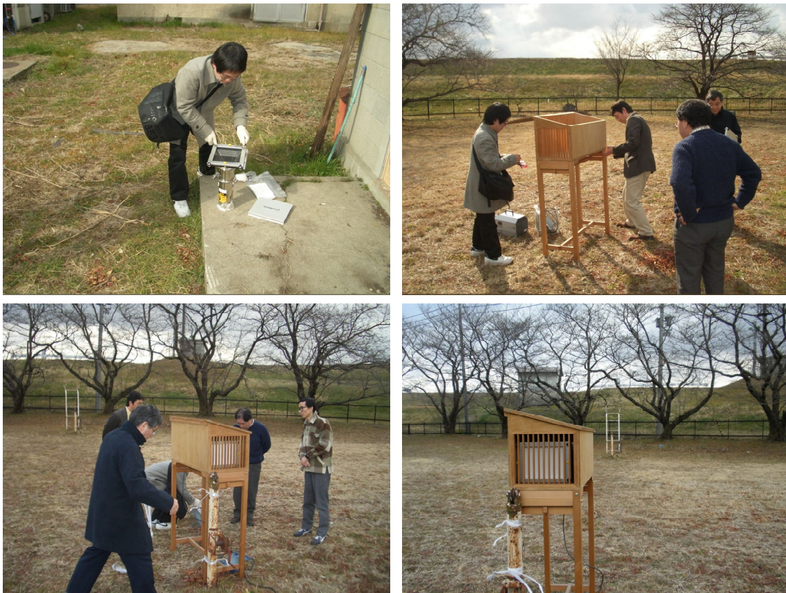
図2 . ハイボリュームエアサンプラー設置の様子。2011年2月10日京都大学防災研究所宇治川オープンラボラトリー構内 (Fushimi)。
