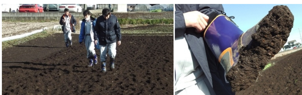
図 II.4 降雨後の畑での歩行試験の様子（左）と靴底への土の付着の程度の一例（右）
