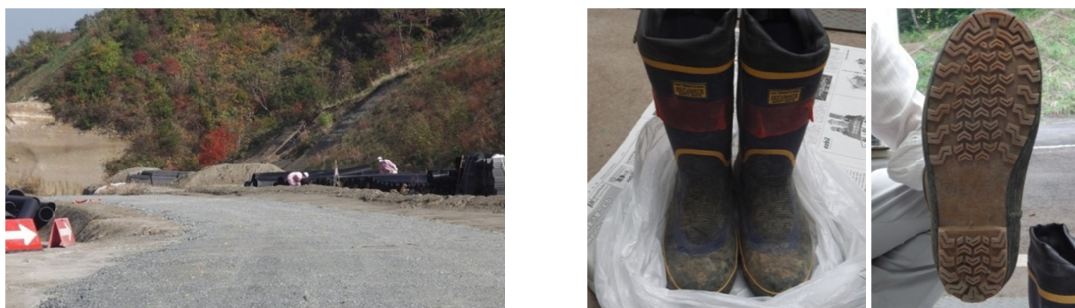
図 III.5 道路工事現場の様子と、最大放射能が観測された長靴への土の付着の状態
