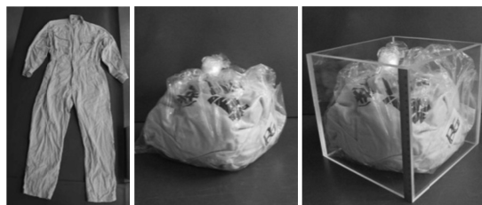
図 III.2 作業服と、それを丸めて一辺 20 cm のアクリル角パイプに詰め込んだ状態
