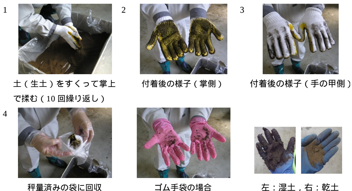
図 II.2 手袋への土壌付着試験の手順
