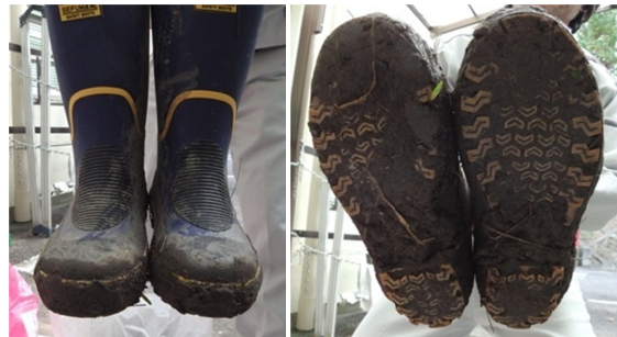
図10 最大放射能が観測された長靴への土の付着の様子 (農地での除染作業に使用された)
