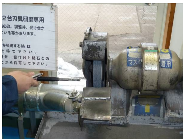
図 6.12 キャノピー式フード開口面における吸引速度測定状況
