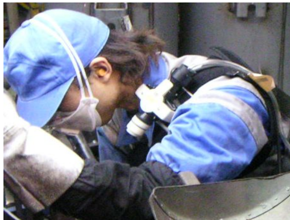
図 1.1 LD-6N デジタル粉じん計の装着状況
