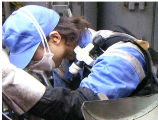
図 3.1 LD-6N デジタル粉じん計の装着状況
