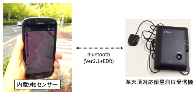
図 6：QZSS、GPS、PDR に基づく測位のためのハードウェア構成
