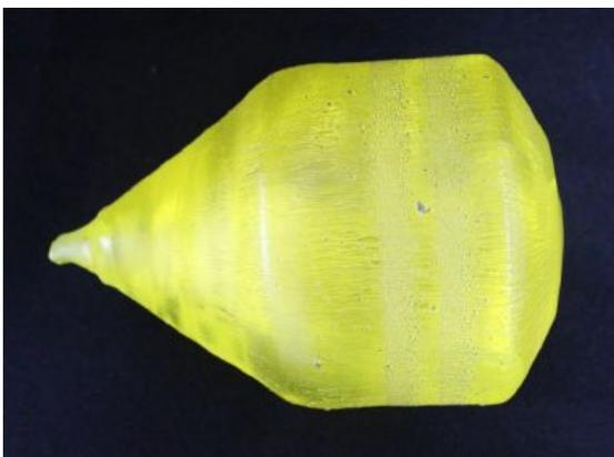
図 10 3インチサイズ Mg 共添加 GAGG 単結晶
