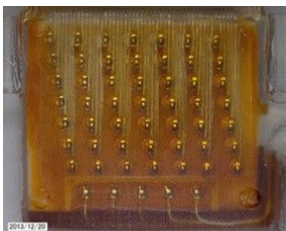
図 7. 49 極配線とセラミック基板接続部拡大
