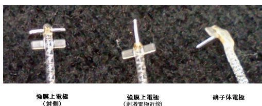
図6 . 表面積が同じの3種類の帰還電極
