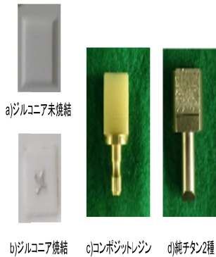
図4. 被切削材料の加工後の表面
