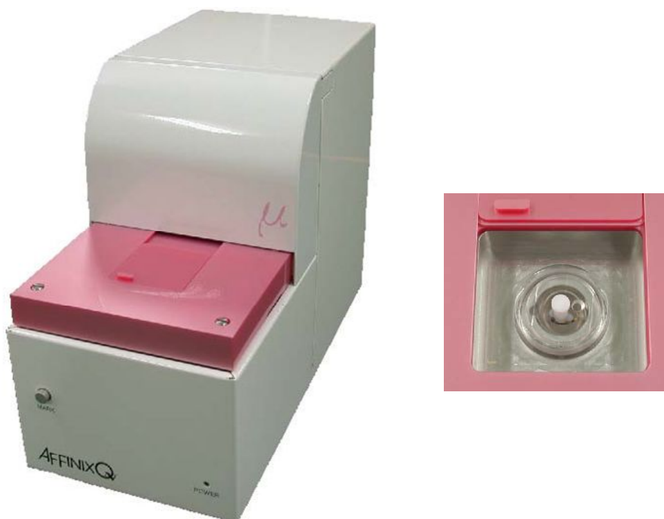
図 3 QCM 装置の外観（左）及び測定部（左）
