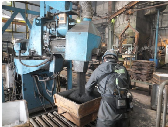
図 2.3 手込め作業風景
