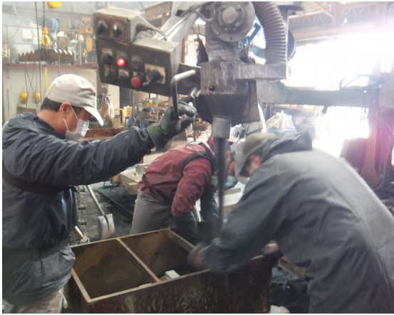
図 2.1 手込め作業風景
