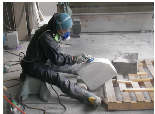
図 1.1 石材に対する研ま・ばり取り作業の様子
