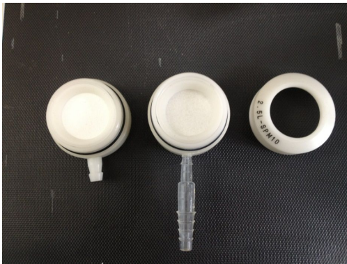
下段 中段 上段 図 4.42 フィルターセット時の オープンフェイスサンプラーの外観
