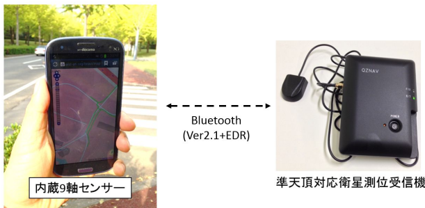
図 2 : QZSS , GPS , PDR に基づく測位のためのハードウェア構成
