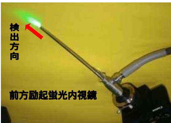
図 17. プロトタイプ蛍光内鏡。上は管壁、腹壁など 90 度側面を観察・光照射することができる。下は在来型の直進方向を観察・光照射する腹腔鏡である。青色光は 430nm の Xenon の光。
