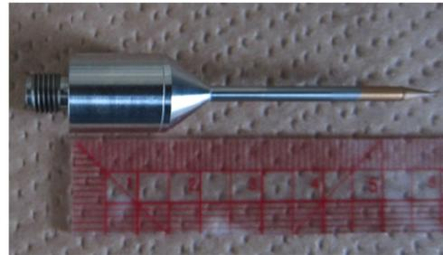
図6 実験に用いたハイドロフオン
