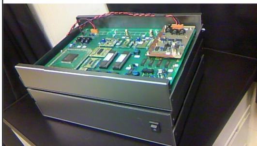
図4 変調超音波出力回路試作機
