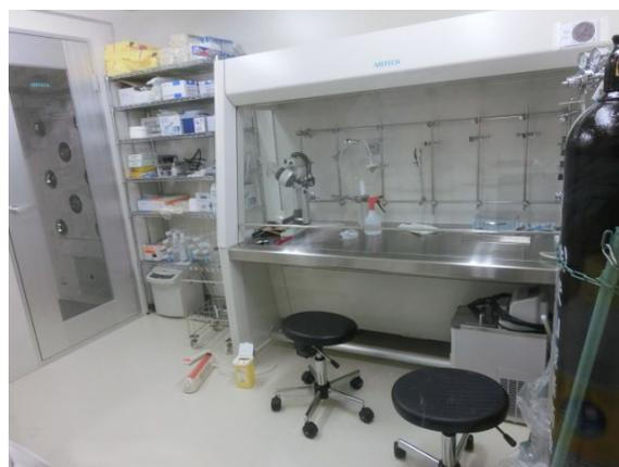
Figure 1. 人工赤血球調製用のクリーンブースとクリーンベンチ (奈良医大 化学教室内)
