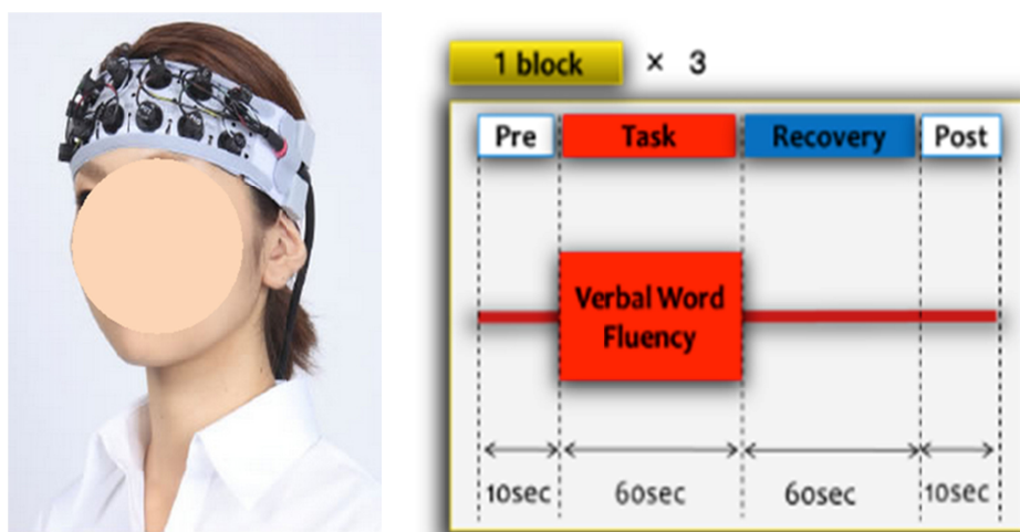
図 2 左：装着例 右：刺激パラダイム
