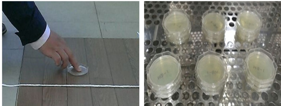
図4 スタンプ培地を用いた表面真菌採集の様子と培養の様子
